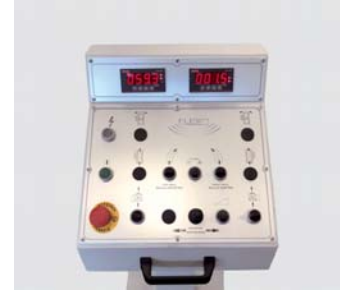
(DI SERIE)2 VISUALIZZATORI DIGITALI PER LA POSIZIONE DEI RULLI INFERIORI (STD) 2 DIGITAL DISPLAY FOR LOWER ROLLS POSITION (STD) 2 DIGITALE ANZEIGEGERATE FUR DIE POSITION WALZEN UNTER
